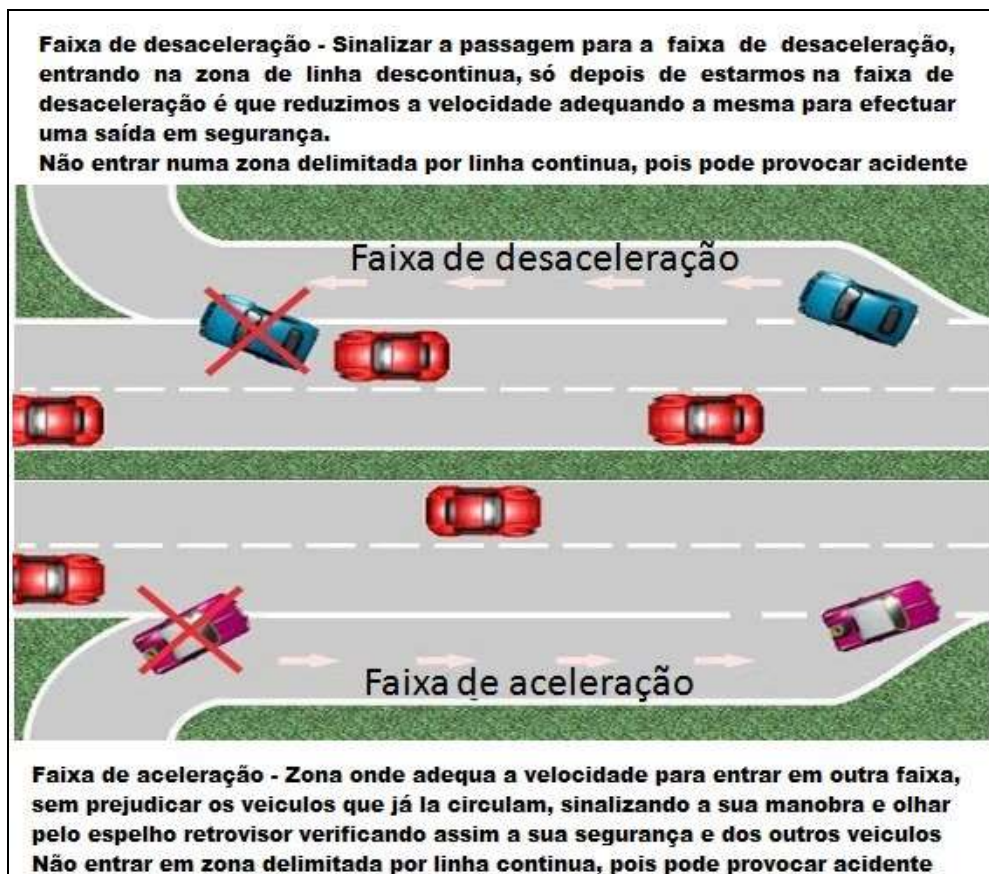
FIGURA 15 – Faixa de desaceleração e de aceleração Fonte: http://blogdainstrutoradetransitomurielutra.blogspot.com.br/2012/10/faixa-de-aceleracao-desaceleracao.html (2015)
